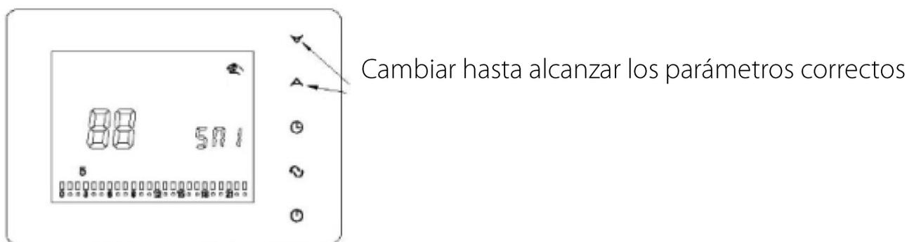
Para el segundo paso, después de que aparezca SN1, presione "aumentar" o "disminuir" para cambiar el número
