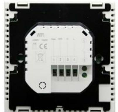
Información: Las conexiones 1 y 2 se utilizan para calefacción por suelo radiante con las conexiones de agente térmico 3 y 4 se utilizan para la alimentación de red,
